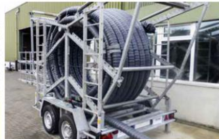
Fig. 3-34 Dérouleur vertical sur une remorque.
