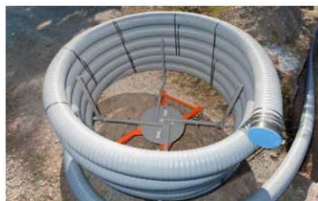
Fig. 3-33 Dérouleur horizontal fixe avec couronne.
